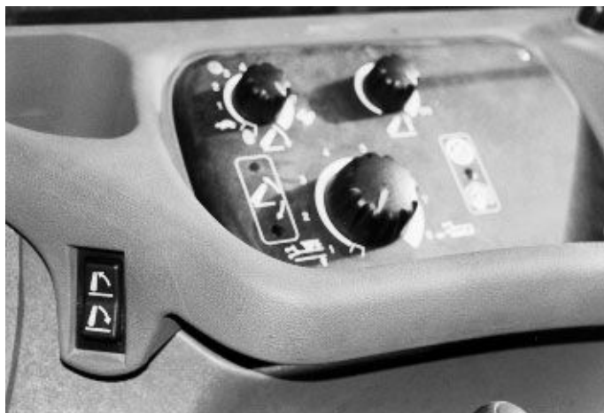
Figuur 8-17: De werkschakelaar van de elektronische hefinrichting, links onder op de foto, is gemakkelijk te bedienen.
