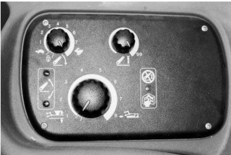
Figuur 8-18: Op het bedieningspaneel zie je de instelmogelijkheden van de hefinrichting.
